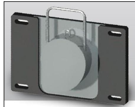
Etant donné les faibles débits de rejet, les ouvrages de limitation de débit seront de type vortex en acier inoxydable de qualité minimale 304 L sur plaque support en PEHD de forte épaisseur.
