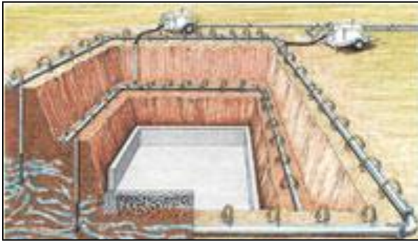
(50) Schéma d'un dispositif de pointes filtrantes périphériques.
