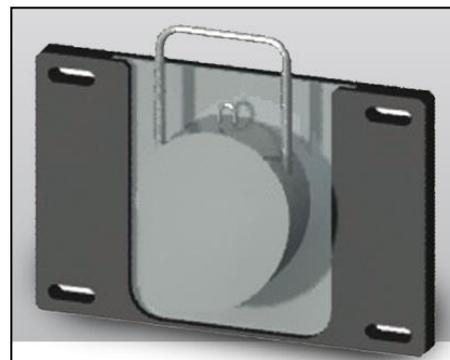
Détail de l'ouvrage de régulation et surverse du bassin d'infiltration :
