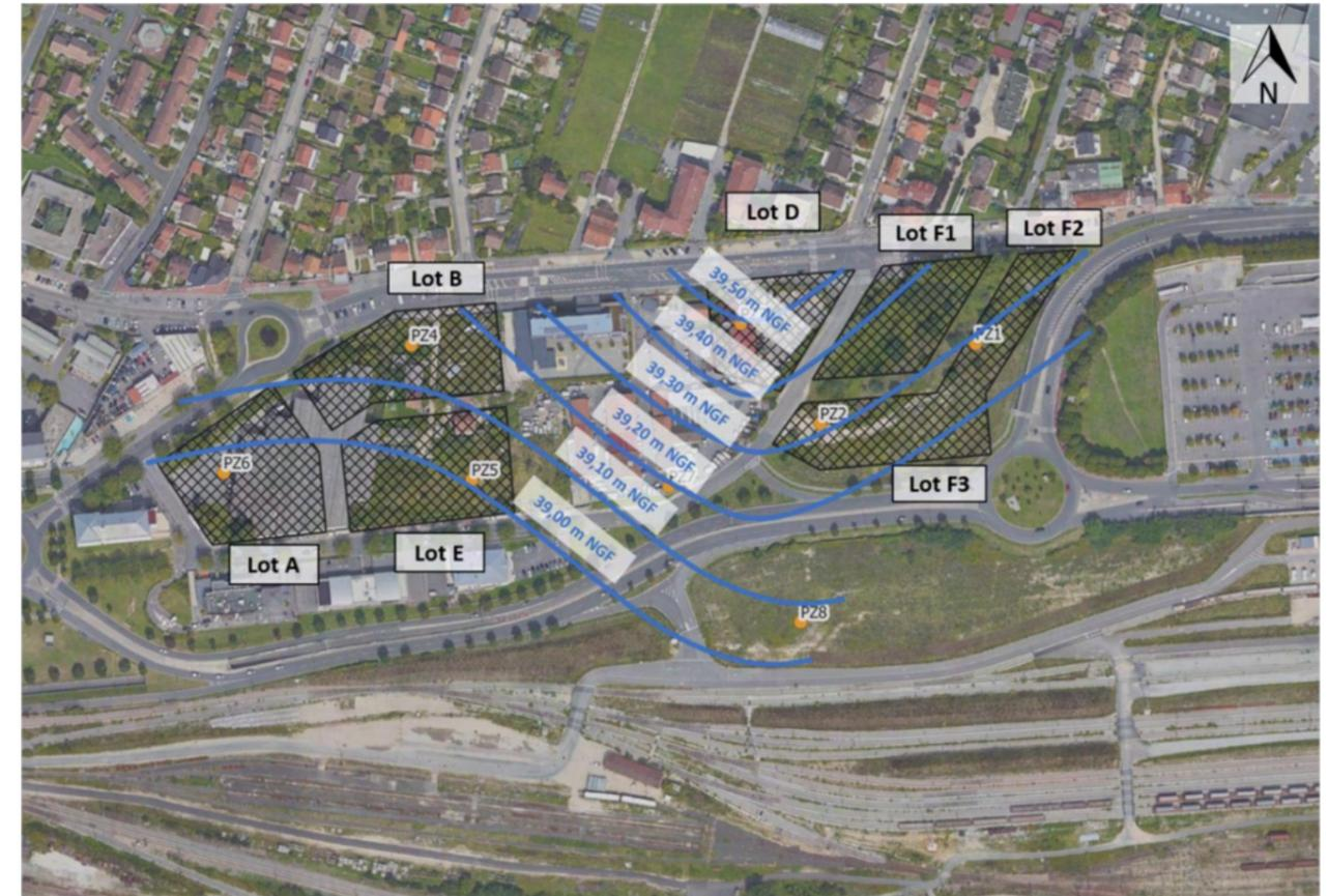
D'après l'ébauche de carte piézométrique l'écoulement de la nappe est orienté vers le Sud- Sud-Ouest, avec un gradient d'environ 0,4%.
