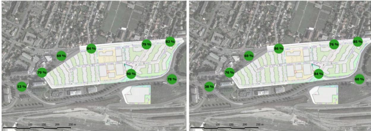
Illustration 111: Situation projetée sans modification des sens de circulation des voies périphériques : analyses statiques de capacité en heure de pointe matin et heure de pointe soir
