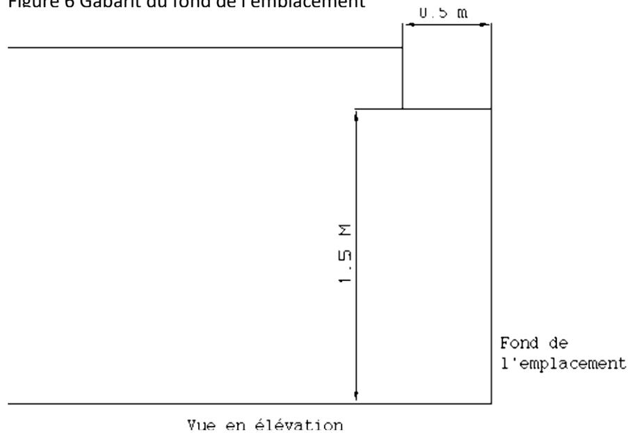
Dans le cas d'un rangement en créneau, l'emplacement doit maintenir dégagé, côté paroi, le gabarit défini par la figure 7.
